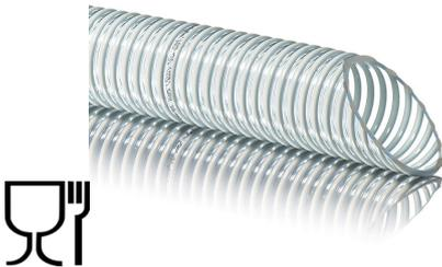
Tuyau d'aspiration et refoulement pour liquides alimentaires à moyenne/ basse pression. Tuyau spiralé en PVC lisse à l'intérieur et plissé à l'extérieur.
