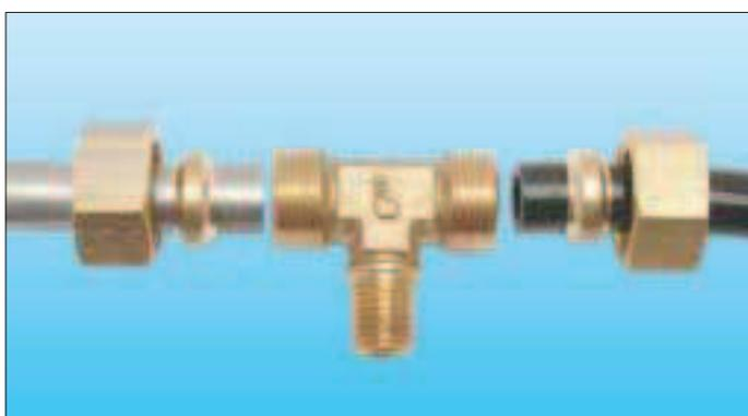
Ce système est dit universel parce qu'il offre aux utilisateurs le maximum de possibilités de raccordements à **montage direct**, et ce avec un minimum de pièces et d'encombrement. Il ne nécessite ni soudure, ni préparation des tubes. Les raccords universels laiton permettent de résoudre tous les problèmes de distribution de fluides et raccordements de tubes, vérins, distributeurs, robinets ...etc., grâce au montage possible de nombreux accessoires : bagues, écrous, réductions, douilles.
